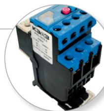
Возможность установки на 35-мм DIN-рейку (другие отечественные производители предлагают подобное крепление только под заказ) и (или) крепление винтами. ПМЛ от 10 А до 32 А (1 и 2 величины) - монтируются на 35 мм DIN-рейку; ПМЛ от 40 А до 100 А (3 и 4 габариты) - монтируются на 35 и 75 мм DIN-рейку.
