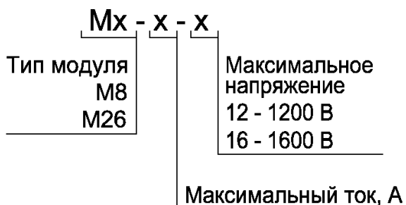
Рисунок 1.1 – Расшифровка названия тиристорных и диодно-тиристорных модулей
