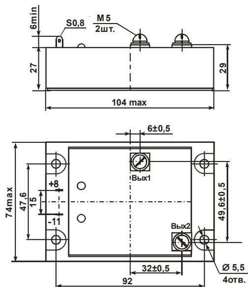
Рисунок 6.3 – Габаритный чертёж модулей МТ16ПТ
