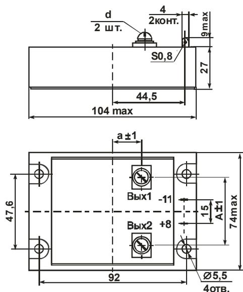
Рисунок 6.2 – Габаритный чертёж модулей МТ16 с максимальным током до 300 А
