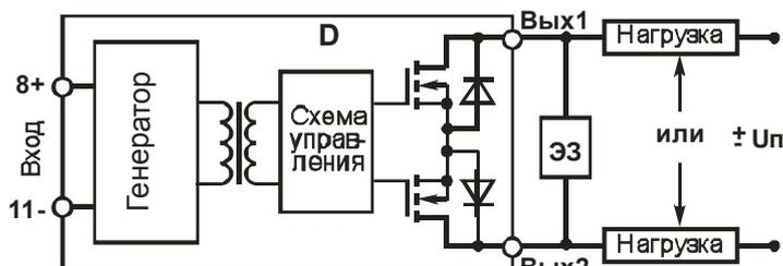
Рисунок 2.2 – Функциональная схема MT16 (рисунок 6.2)
