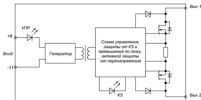
Рисунок 2.3 – Функциональная схема MT16ПТ (рисунок 6.3)
