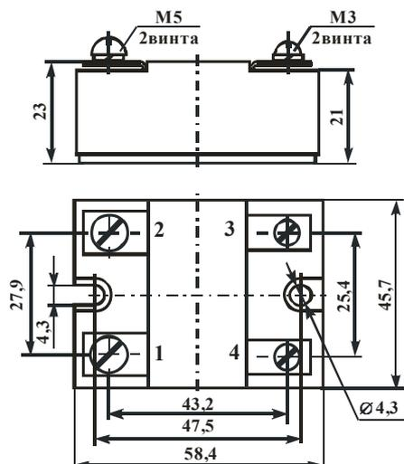
Рисунок 6.1 – Габаритный чертёж модулей МТ16 с максимальным током до 40 А
