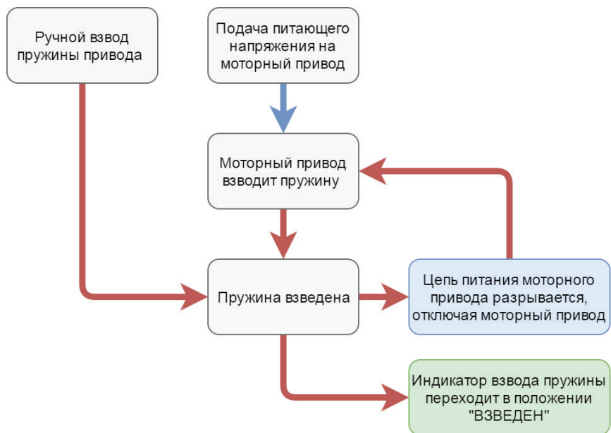
Рисунок Г.1 – Описание процесса взвода пружины привода
