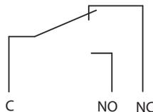
Состояние контактов с установленным сигнальным контактом VL50 на плавкой вставке: предохранитель не расплавлен - контакты C – NC замкнуты.
